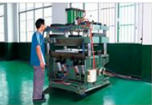
門框成型機 Door steel forming machine
