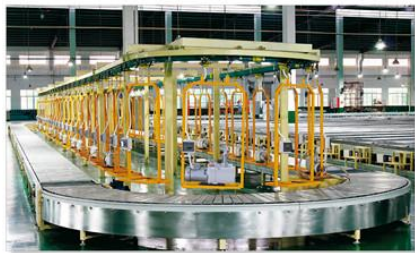
真空吸盤機 Vacuum extractor line
